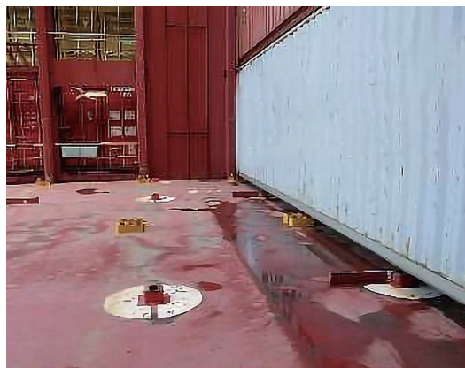
写真 22 コンテナ船のポンツーンカバー、適切にマーキングされている
