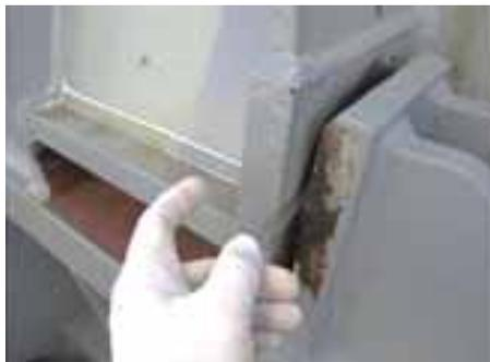
写真 14 フィラーゲージで隙間を測定
