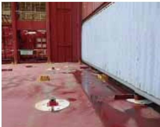
写真 22 コンテナ船のポンツーンカバー、適切にマーキングされている
