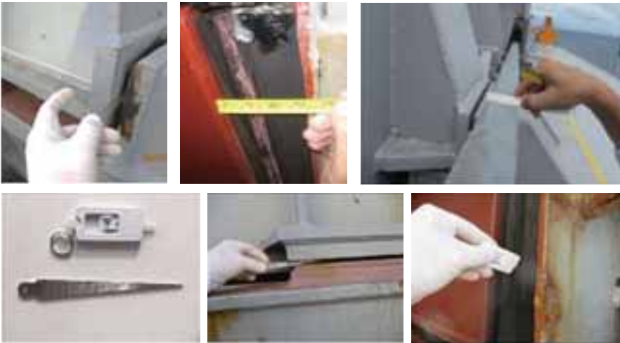
写真3 フィラーゲージ、物差し、デプスゲージ等を使用した検査の様子
