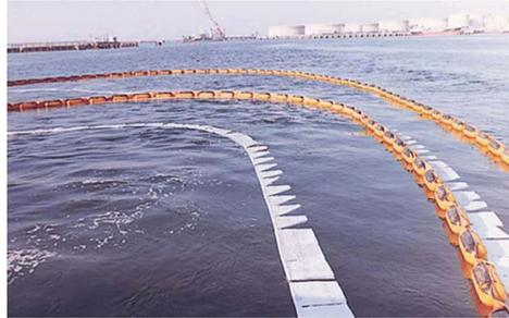
写真6 油吸着マット使用例
