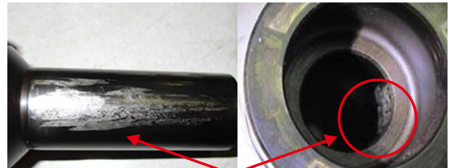
写真 5-14 燃料噴射弁での掻き傷
