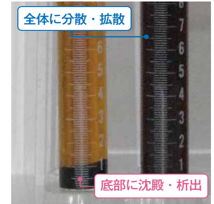
写真 5-6 底部にスラッジ沈殿・析出
