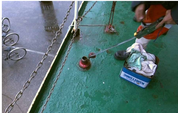
写真 4-2 (a) 補油作業 タンク液位実測
