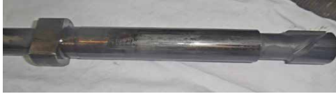
燃料噴射ポンプ : プランジヤはバレルに完全に焼付き。
