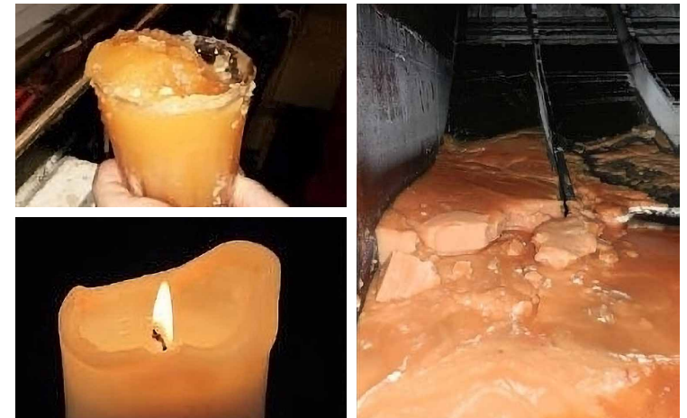
写真 5-22 タンク内で析出したワックス分
