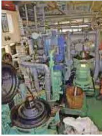
1時間通油後のC重油清浄機 : 重質&硬いスラッジで閉塞。
