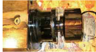
燃料加圧プランジヤがバレルに固着。
