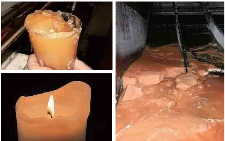
写真 5-22 タンク内で析出したワックス分
