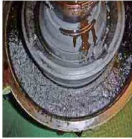
1時間通油後のC重油清浄機 : 重質&硬いスラッジで閉塞。
