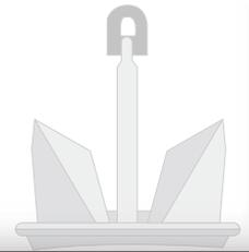
船舶が錨泊する際、通常は両舷に搭載した錨のうち片方の錨を投じて単錨泊を行っています。しかし、台風などによる強風・暴風に対する走錨防止対策として、反対舷の錨を海底まで垂らす振れ止め錨の併用や、二錨泊・双錨泊の態勢をとることもあります。(図1参照)
