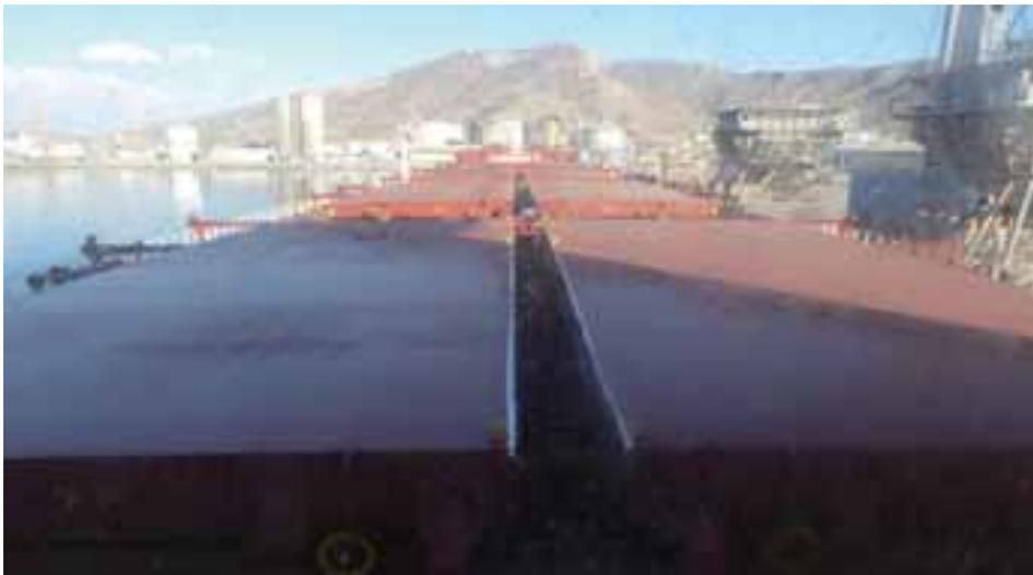
船が静止状態にあり、自然換気は限定されるため、より空気交換を促進するため、ローリングタイプのハッチカバーを僅かに開けた状態。
