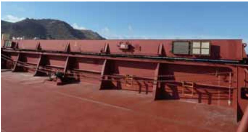
ばら積み貨物船の自然換気。右舷前方および後方のハッチパネルの通気口が開状態。着岸中の船体は静止状態にあり、自然換気は限定されるため、より空気交換を促進するためにハッチカバーをジャッキアップしている。
