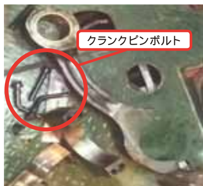
参考写真 34 曲損した接続棒
