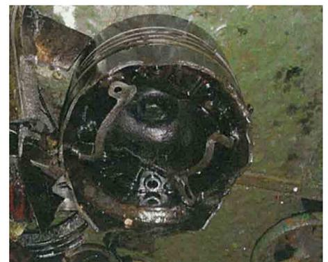
参考写真 36 割損したピストン
