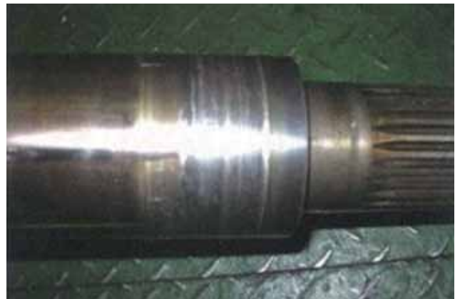
d) 過給機ロータ軸の揺き傷 2014 年度 出力低減
