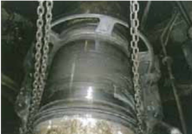
a) 焼損した中間軸 2013 年度 自航不能
