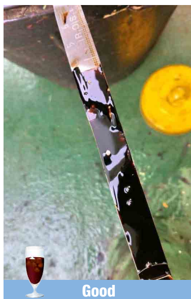
図 81 【正常状態】 テープに泡なし（きれいな光沢反射） 参考文献 *19
