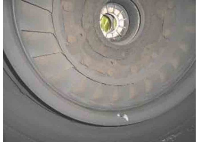
図 18 曲損したノズルリング 参考文献*7
