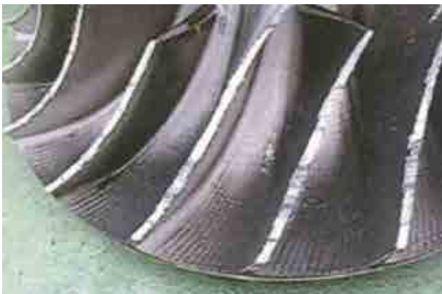
e) インペラのケーシング接触による磨耗 2013 年度 出力低減
