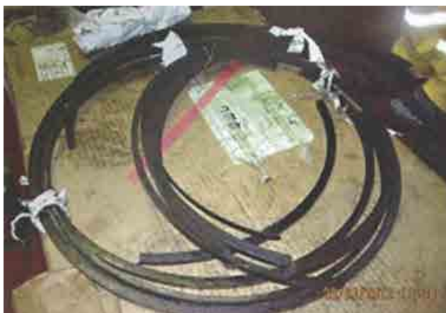
e) 破損したピストンリング 2012年度 出力低減
