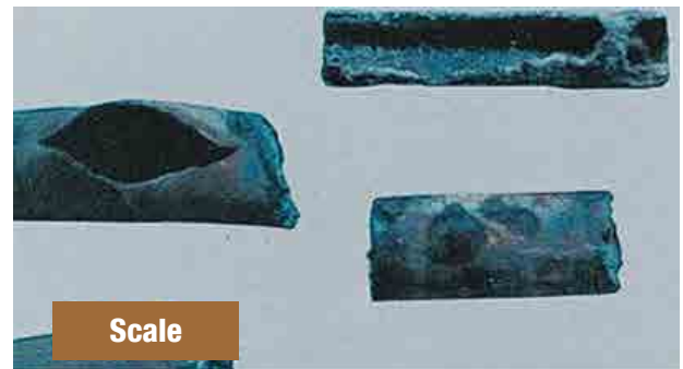
図 39 スケールが原因による破孔 参考文献*12
