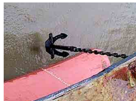
図 49 錨鎖と錨の動作確認作業
