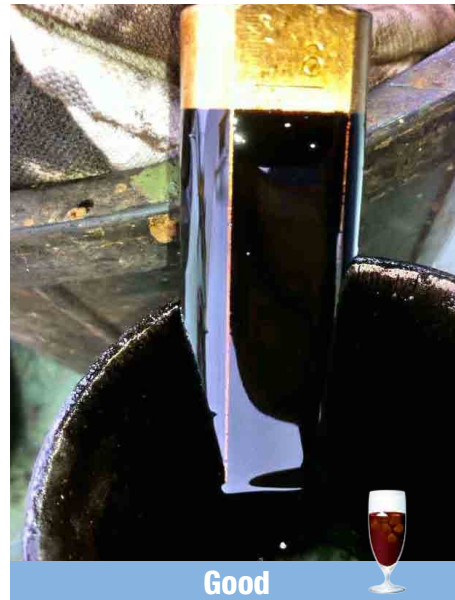
図 83 【正常な状態】 テープ先のおもりに泡付着無し (きれいな光沢反射) 参考文献 *19
