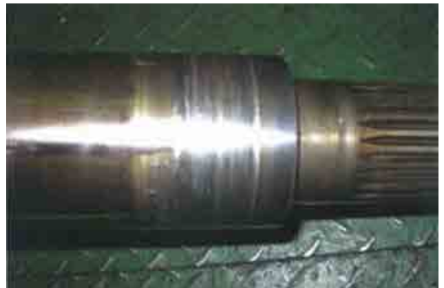
d) 過給機ロータ軸の掻き傷 2014 年度 出力低減
