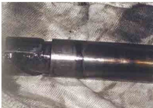
f) 磨耗したプランジャー 2012年度 出力低減 低質燃料
