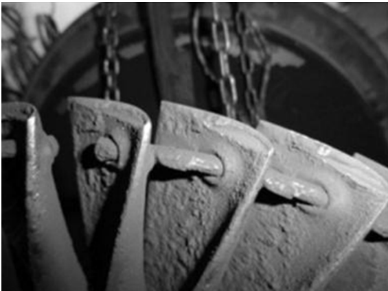
図 20 タービン翼に付着した炭素 参考文献 *7
