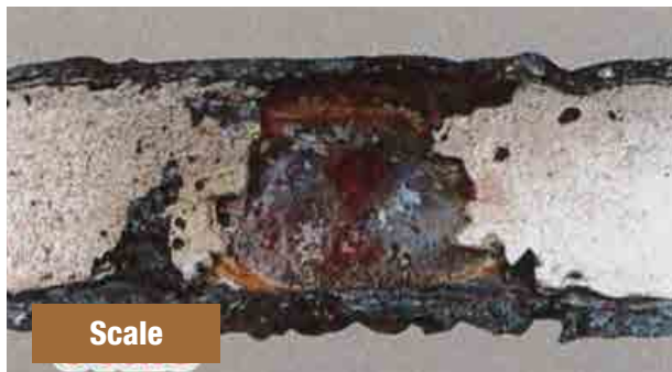
図 38 スケールが原因による破孔 参考文献*12
