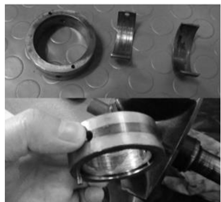
図 23 油穴位置のずれた軸受 参考文献 *7
