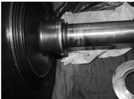
図 22 掻き傷が発生したローター軸 参考文献 *7
