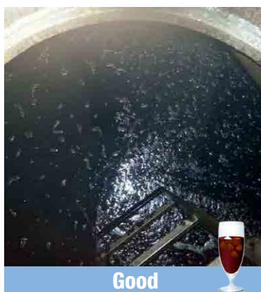
図 79 【正常状態】 補油 6 時間後：気泡がない状態 参考文献 *19
