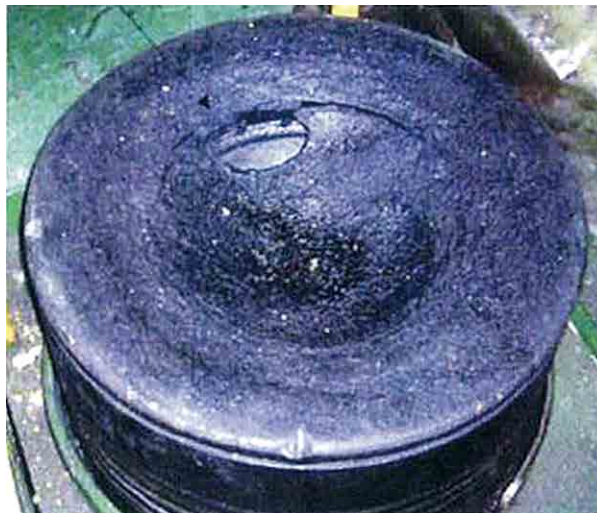
図 26 破孔したピストンクラウン 2009 年度 自航不能 整備不良と修理時のミス 参考文献*11
