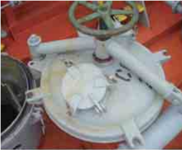
マンホールハッチ
