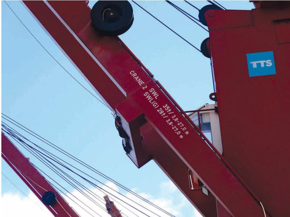
写真 8 ジブの側面にフック時の安全荷重 35 トン、グラブ時の安全荷重 28 トンと明記
