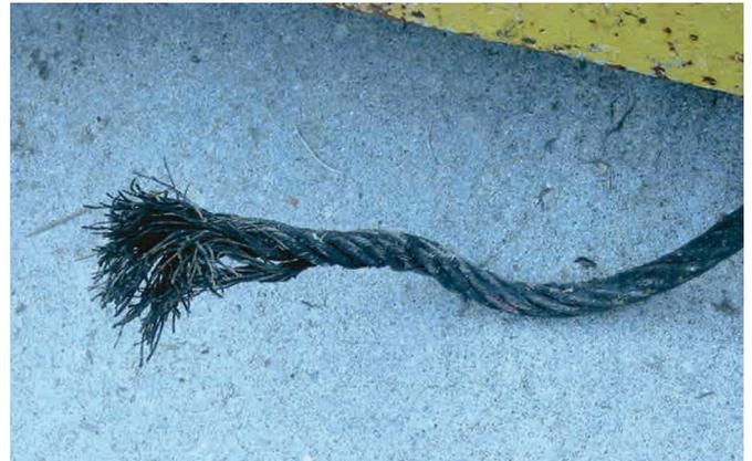
写真7 過重な荷物を積載し、ワイヤーに不具合が生じた例
