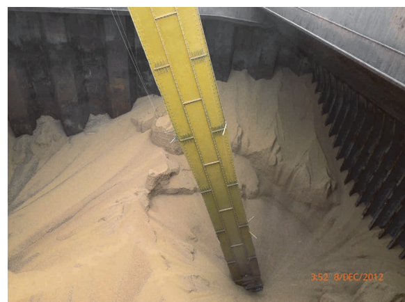
No.6 バケットコンベアを使用して穀物を揚げる様子 No.6 Off-loading of a grain cargo by bucket conveyor leg.
