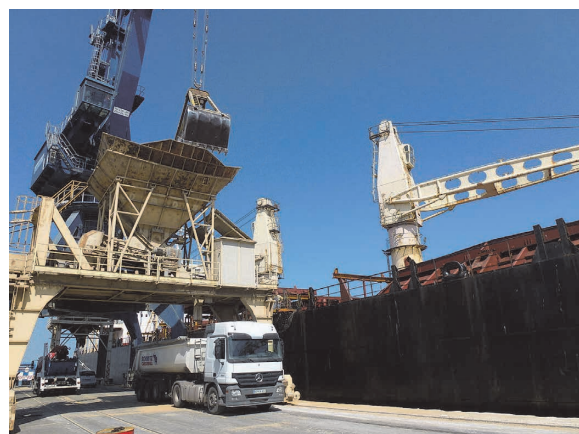
No.7 グラブを使用して陸上のホッパーに穀物を揚げ、路上で待機する車両に積込む様子 No.7 Off-loading by grab to an on-shore hopper which delivers the grain to waiting road vehicles.
