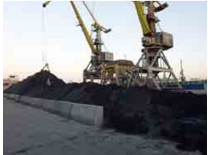
写真8 陸上クレーンのグラブを使用して積荷役を行う様子 Fig.8 Loading by grabs fitted to on-shore cranes.
