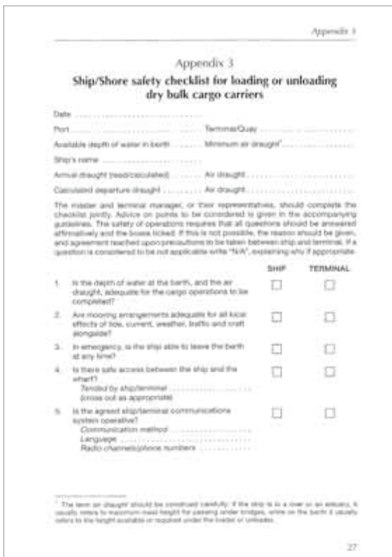
図3 BLU コード Appendix 3 の1ページ ばら積貨物の積・揚荷役に関する船陸チェックリスト。続きは“Code of Safe Practice for the Safe Loading and Unloading of Bulk Carriers”の28-29ページを参照。
