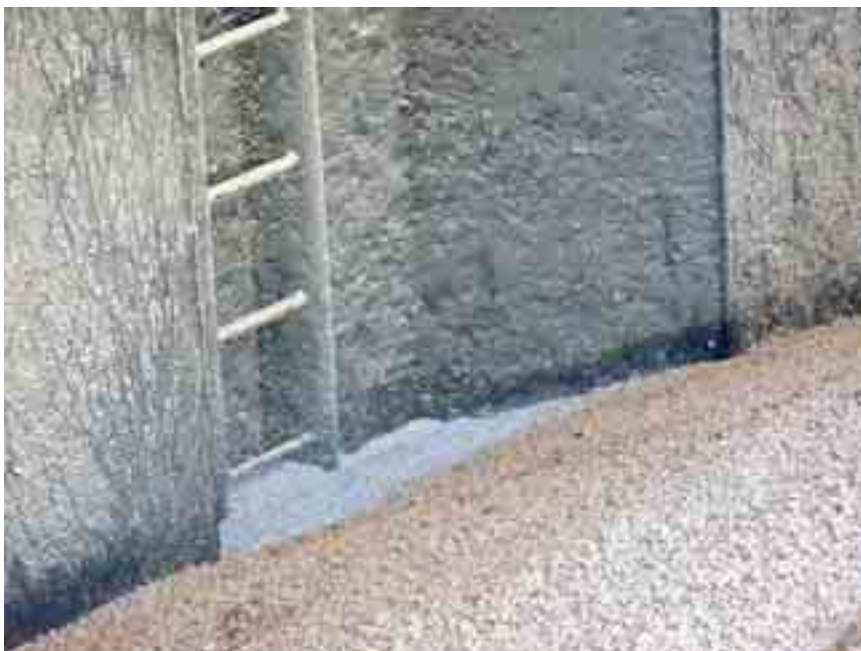
写真 11 艙内に動物の飼料を積載。燻蒸剤が単にアクセスハッチ下のみ撒かれたため、艙内ラダー下部に片寄った状態で溜まっている。燻蒸の失敗例。
