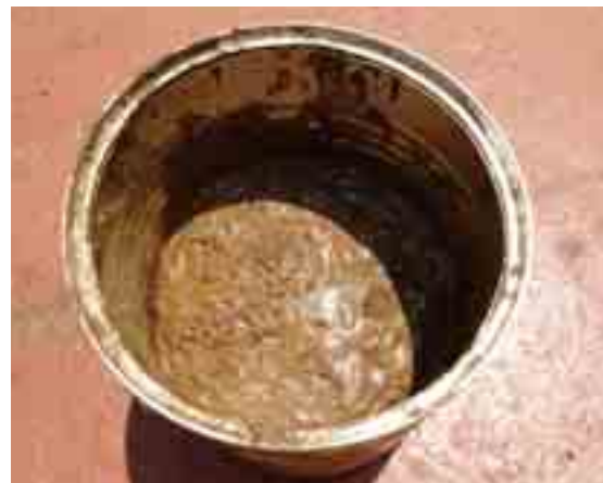
写真6 “缶テスト”実施後の同左サンプル 結果不合格
