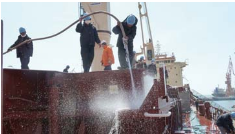
写真 14 ハッチカバーのホーステスト( 或いはウルトラソニックテスト) は非常に重要な本船準備作業のひとつ
