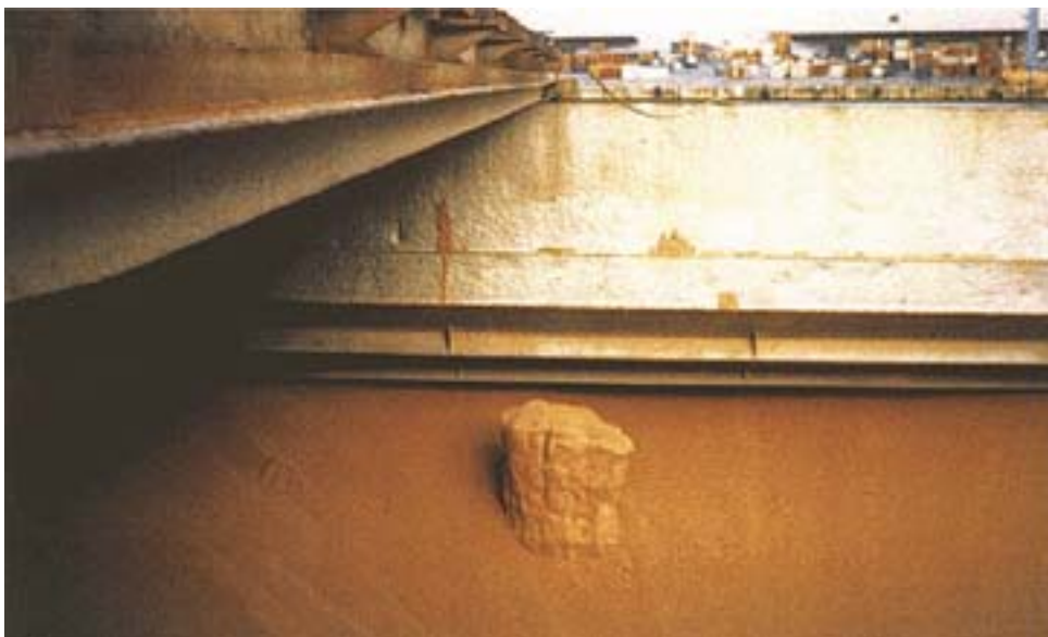
写真 15 ハッチカバー接合部から海水が度々浸水、濡れ損・カビが発生した部分の穀物が柱状になったもの
