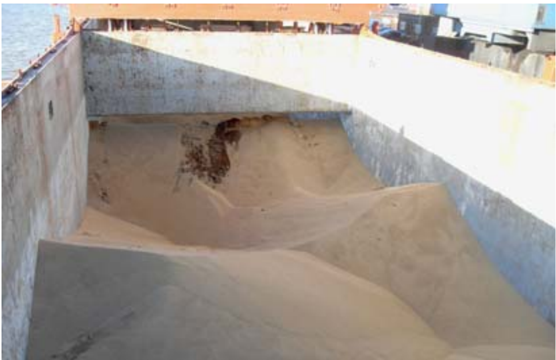
写真 16 船首端及びハッチカバー接合部に浸水による穀物の濡れ損が発生
