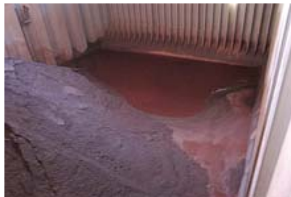
写真 2 鉄鉱石中の自由水が貨物の山から浸み出た状態。本船の横揺れにより貨物が片側に移動する可能性がある。
