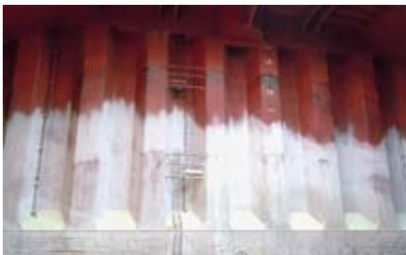
写真 11 硫黄揚荷後のライムコーティングの状態。隔壁の下部に見られるスクラッチは揚荷作業によるもの。
