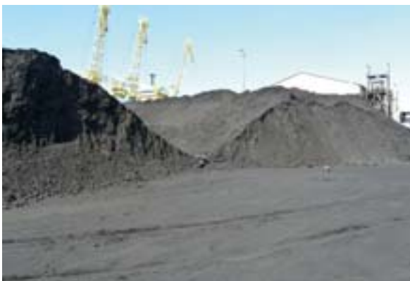
写真 1 戸外に蔵置された貨物。貨物が覆われていないため、テストを行わなければ、正しい MC (含有水分値) 及び TML (運送許容水分値) が判明しない。
