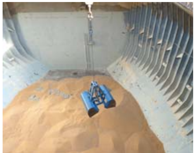
写真 13 異常のない貨物の分離作業には時間を要する。また、貨物底部の濡れ損により、穀物の大部分の品質が格下げされた。
