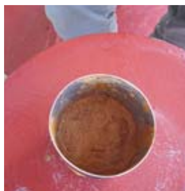
写真4 “缶テスト”実施後の同上サンプル 結果不合格 Fig.4 The same sample of cargo after the "can test" which it failed.
