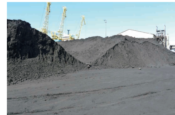
写真 1 戸外に蔵置された貨物。貨物が覆われていないため、テストを行わなければ、正しい MC（含有水分値）及び TML（運送許容水分値）が判明しない。 Fig.1 Stockpiled cargo. The cargo is not covered and without the results of tests the moisture content (MC) and transportable moisture limit (TML) cannot be known.
