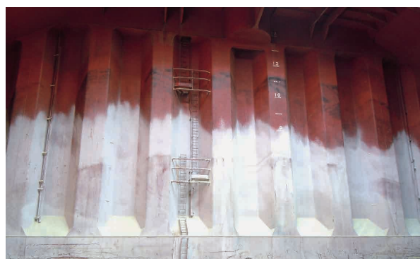
写真 11 硫黄揚荷後のライムコーティングの状態。隔壁の下部に見られるスクラッチは揚荷作業によるもの。
