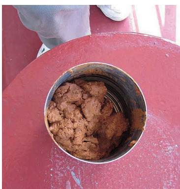
写真 3 “缶テスト”実施前の貨物サンプル Fig.3 A sample of cargo in a can before a "can test".
