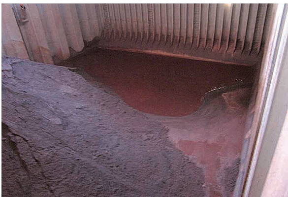
写真 2 鉄鉱石中の自由水が貨物の山から浸み出た状態。本船の横揺れにより貨物が片側に移動する可能性がある。 Fig.2 Iron ore cargo exhibiting free moisture on top of the cargo outboard of the pile of cargo. The cargo might shift to one side of the hold as the vessel rolls.
