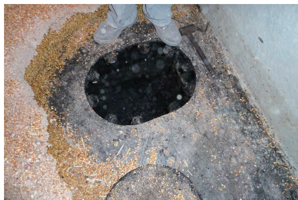
写真 12 ビルジシステムを通じてビルジが艀内に逆流、タンクトップ上最大 250mm の高さまでの貨物が濡れ、変色、損害が発生した。タンクトップ上の広い範囲で濡れ損が発生した。
