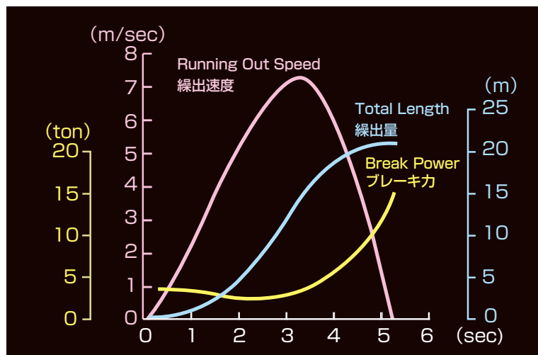
VLCC 投錨実験結果 / Result of VLCC Anchoring グラフ 1 / graph 1
