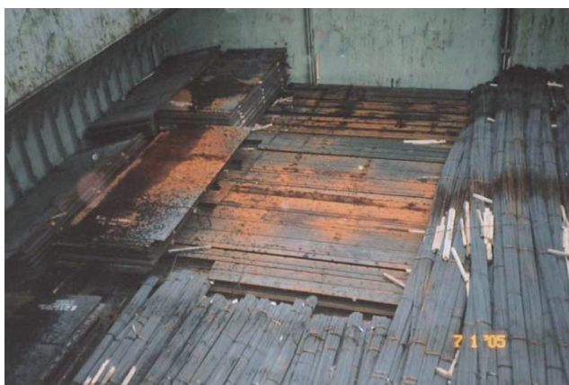
写真 2 - 海水による鋼板や棒鋼の発錆
