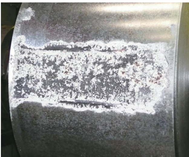
写真 4 - アンコイラーでコイルを解くと、鋼材の表面に白い錆がみられた
