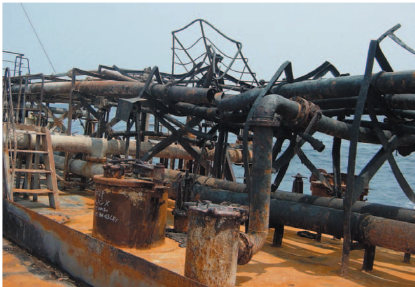
写真1 火炎に曝された右舷側タンク、配管類（ガスケットは効果が無くなっている） Photo No.1 Deadly burned starboard side tanks and pipes (the gasket has become useless)
