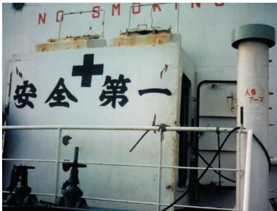
写真6 爆風によりポンプルームの入り口正面が丸みを帯びている(ベンゼンタンカー)
