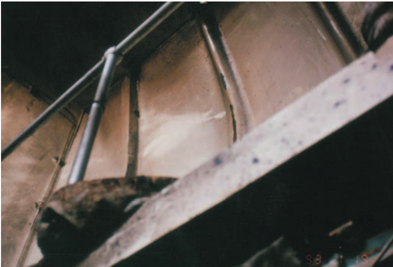
写真5 爆発により丸みを帯びたエンジンルーム内部の壁(ナフサタンカー) Photo No.5 Ballooned inner wall of the engine room due to the explosion (Naphtha carrier)
