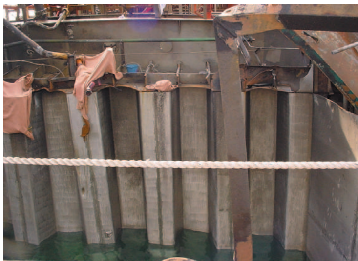
写真8 爆発して上甲板が吹き飛んだNo.2センタータンク（艀から艀を見る） 濡れ毛布でNo.3センタータンクの艀側破孔部を覆っている
