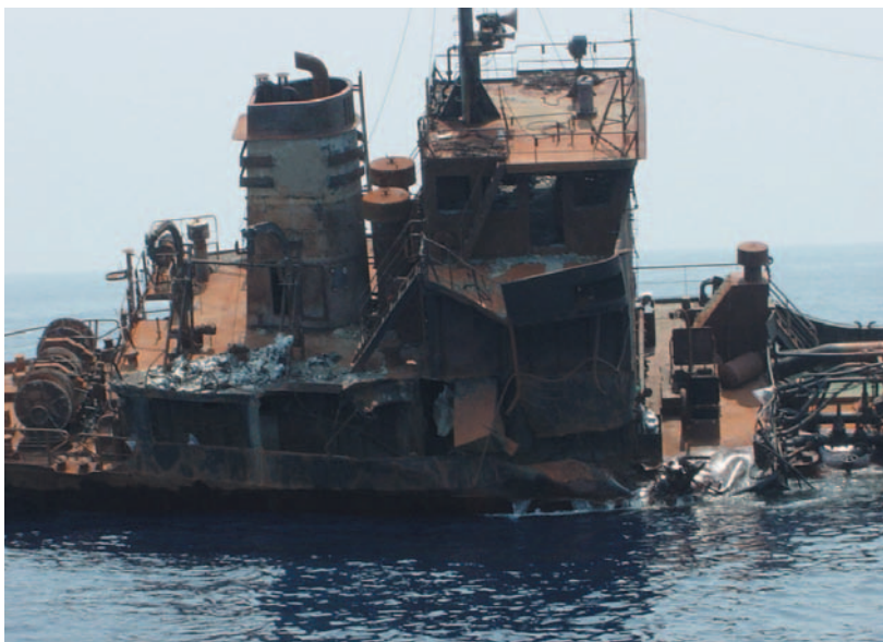
写真1 火炎に曝された右舷側タンク、配管類（ガスケットは効果が無くなっている） Photo No.1 Deadly burned starboard side tanks and pipes (the gasket has become useless)
