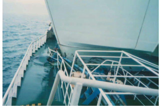
写真4 フェリーの船首部分がアクリロニトリルタンカーの真横に突き刺さっている Photo No.4 The bow of the car ferry denting the side of the Acrylonitrile carrier
