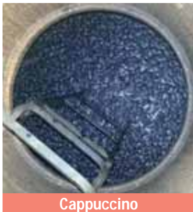
図 78 【カプチーノ状態】 補油 2 後時間：激しい泡々状態 参考文献 *19
