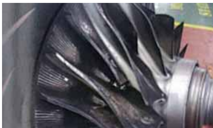
図 24 過給機コンプレッサ翼の掻き傷 2014 年度出力低減 潤滑油不足 参考文献 *4
