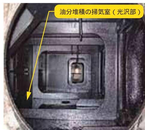
図 16 油分が堆積した状態の掃気室 参考文献 *7
