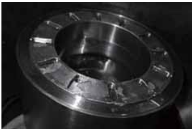
図 19 メタルが剥離したスラスト軸受 参考文献 *7
