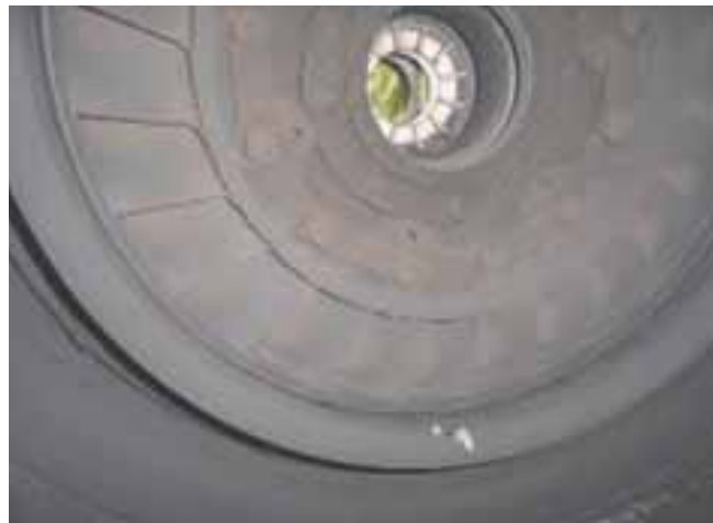
図 18 曲損したノズルリング 参考文献 *7
