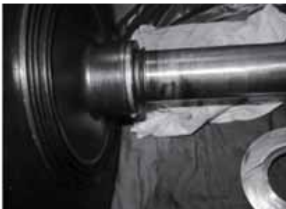
図 22 揺き傷が発生したローター軸 参考文献 *7
