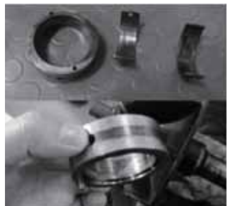
図 23 油穴位置のずれた軸受 参考文献 *7
