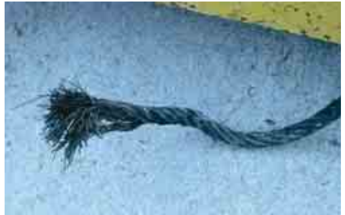
写真 7 過重な荷物を積載し、ワイヤーに不具合が生じた例
