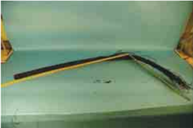
写真 7 過重な荷物を積載し、ワイヤーに不具合が生じた例
