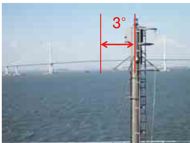
参考写真：橋の中央を通過させるため、リーウェイを右3度程度取っている。
