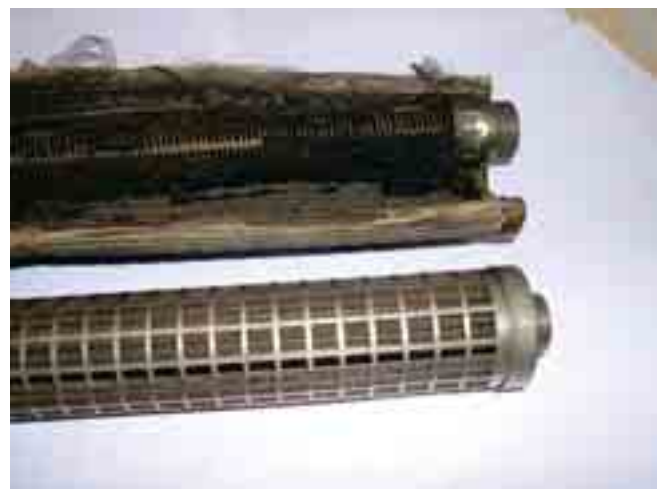
微粒子の混入による精密フィルターの閉塞 Fine fuel filter choked with particulate matter
