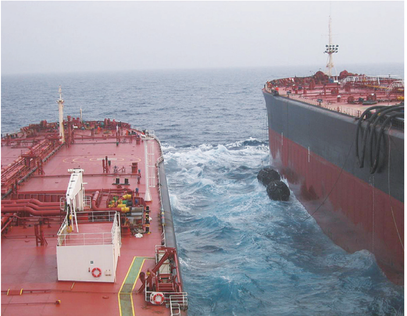
STS operation のために接近する二隻のタンカー Two tankers coming together for STS operations:
