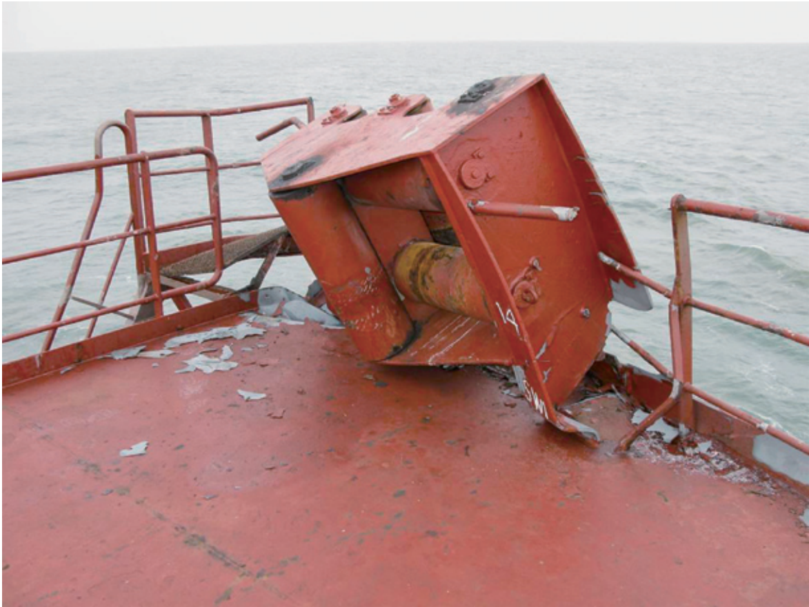
STS の最中に発生した衝突事故の例
