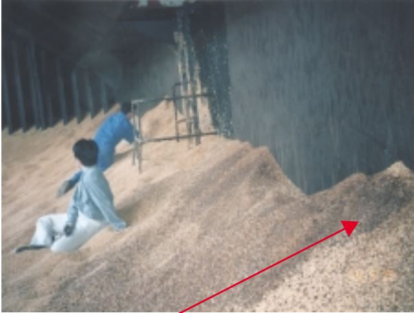
1番船倉前面側壁に沿った損傷貨物
