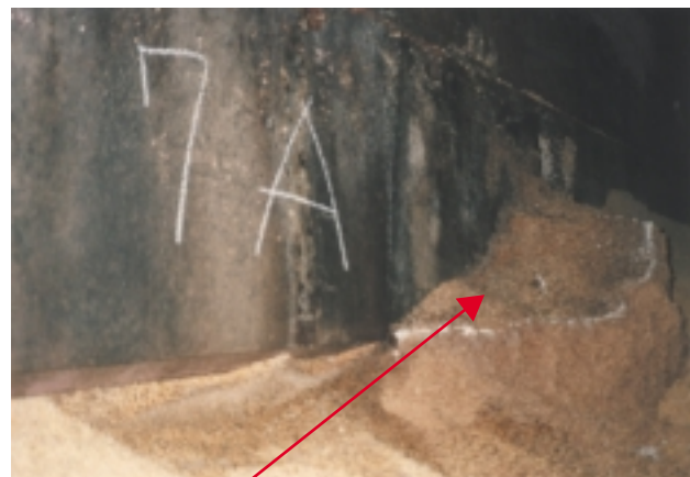
7番船倉後部隔壁に沿って著しく変色・Cakingした貨物
