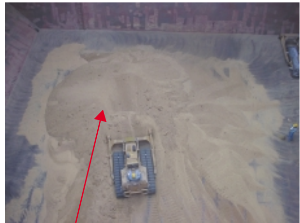
ブルドーザーで集められている損傷貨物
