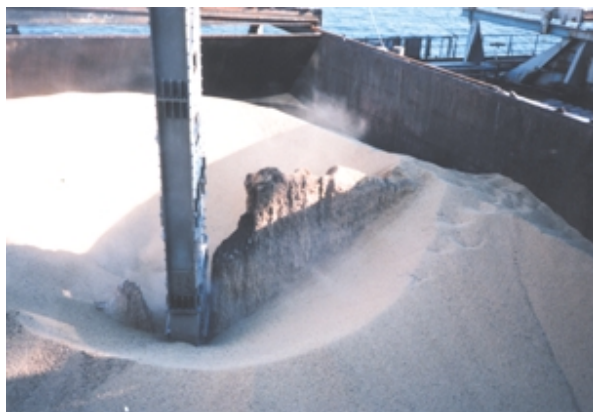
Side rolling typeのhatch cover で、両舷 Panels 接合部(本船Center line)直下貨物表面の受損状態。
