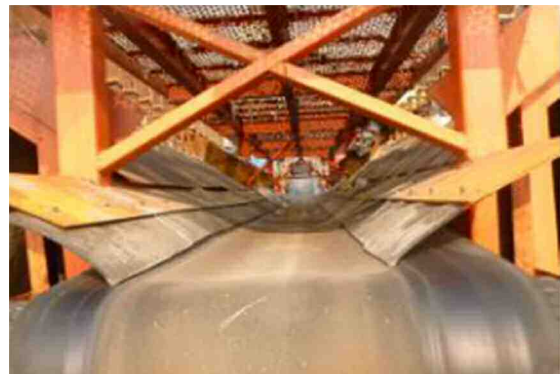
コンベアベルト上にある金属製格子を介して肥料がベルトへ落とされる
